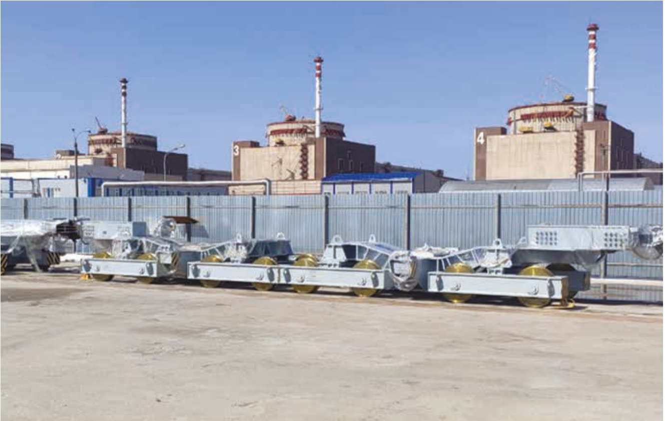
Высокоманевренная платформа г/п 35т, с автоматической навигацией по полосе, самозагрузкой и лидарами — датчиками столкновения
