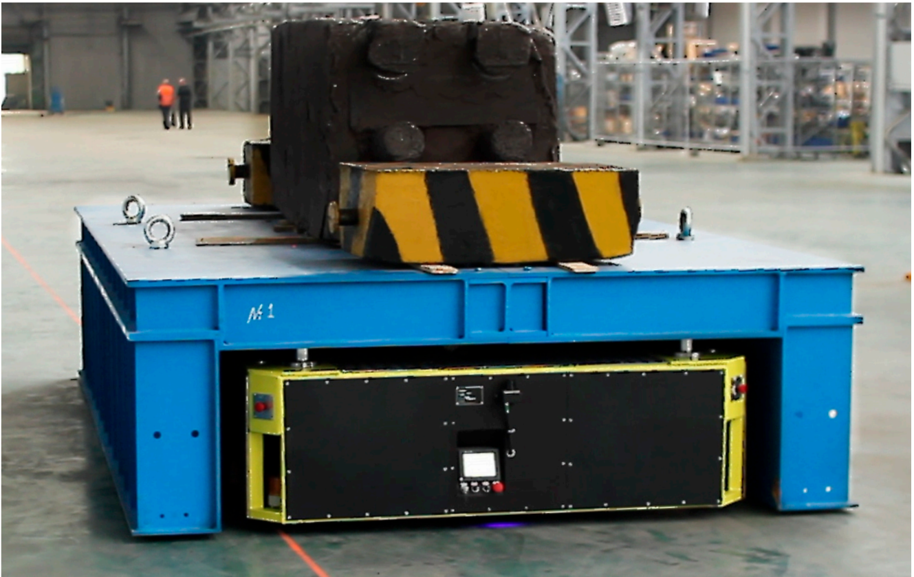
Высокоманевренная платформа г/п 35т, с автоматической навигацией по полосе, самозагрузкой и лидарами — датчиками столкновения
